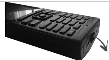
Enchufe el cable USB en la toma USB del teléfono. Enchufe el otro extremo del cable USB en el adaptador CA/CC o en un enchufe USB de ordenador.
