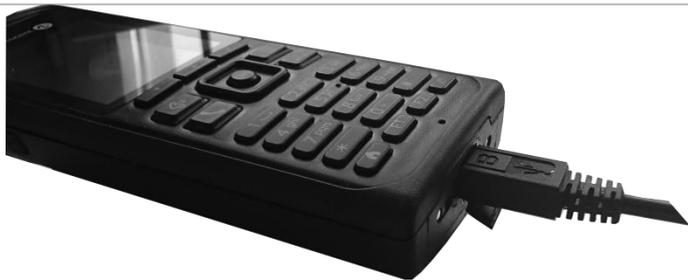
Enchufe el cable USB en la toma USB del teléfono. Enchufe el otro extremo del cable USB en el adaptador CA/CC o en un enchufe USB de ordenador.
