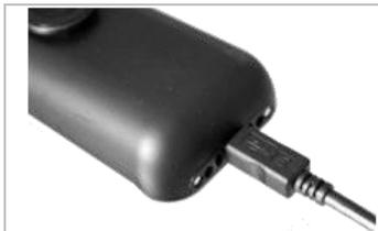
Enchufe el cable USB en la toma USB del teléfono. Enchufe el otro extremo del cable USB en el adaptador CA/CC o en un enchufe USB de ordenador.
