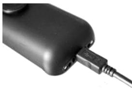
Enchufe el cable USB en la toma USB del teléfono. Enchufe el otro extremo del cable USB en el adaptador CA/CC o en un enchufe USB de ordenador.
